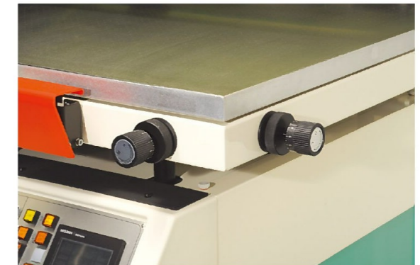
堅牢なSUSテーブルトップ、精密、正確な位置合わせ
