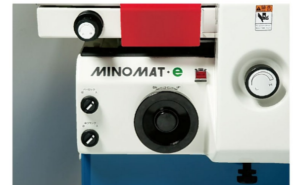
ワンタッチ版固定スイッチと版間隔量調整ハンドル
